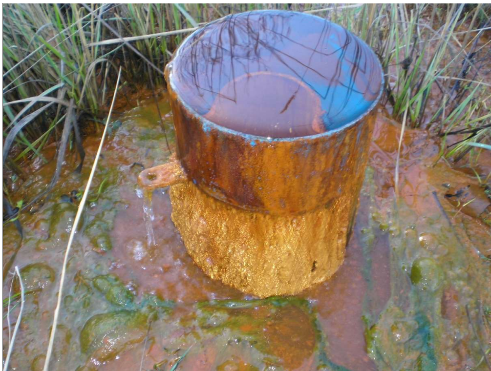
Snímek 20: poklesová oblast 4 – odkaliště ČSM-Polenčí , vrt V-529 před jeho zatopením. Poklesy terénu zvýšily napjatost ve zvodni až do pozitivní piezometrické úrovně (artés) – podzemní voda vytékala stvolem vrtu na terén.
